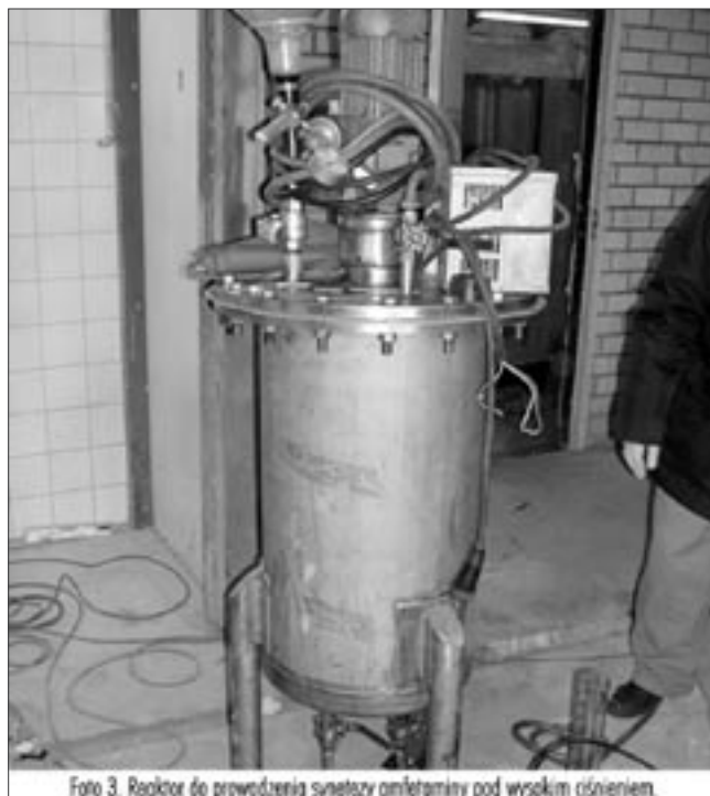
Foto 3. Reaktor do prowadzenia syntezy amfetaminy pod wysokim ciśnieniem.
